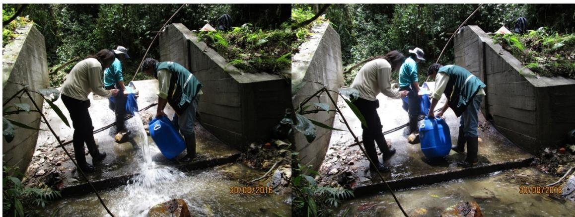
Foto 12. Medición de caudal en la Q. Guapante Parte alta ( Junto a la bocatoma del acueducto)
