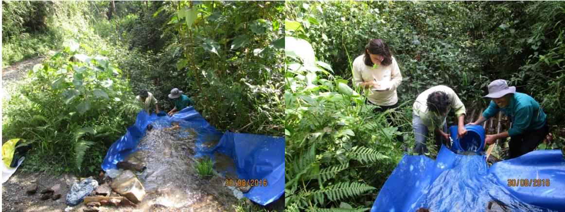
Foto 10. Medición de caudal en la Q. Guapante parte media-alta (a la altura del cruce con la vía, parte baja de la reserva La Guapante)
