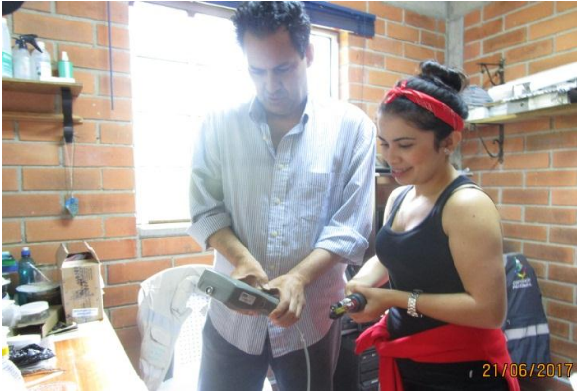
Figura 6. Calibración del equipo multiparamétrico para muestreos físicos y químicos
