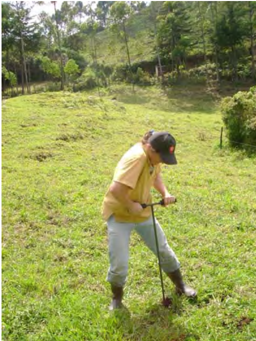
Foto 72 y 73 Actividad de barrenado para tomar las muestras de suelos, y medida de los horizontes A y B en el perfil del suelo
