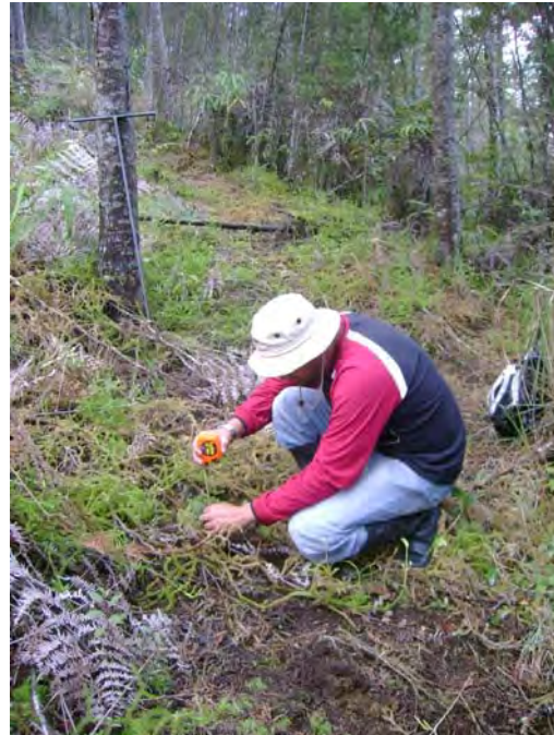
Foto 72 y 73 Actividad de barrenado para tomar las muestras de suelos, y medida de los horizontes A y B en el perfil del suelo
